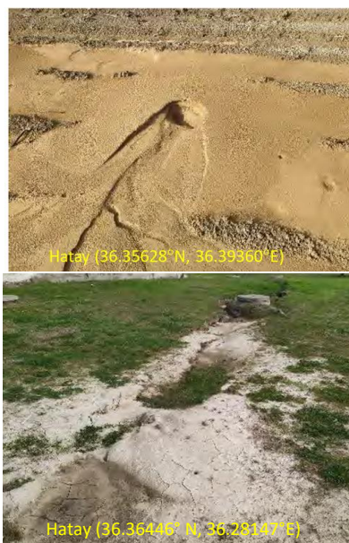
شکل (۸): روانگرایی و گسترش جانبی خاک در شهرهای آدیامان، گلباشی و حاتای
