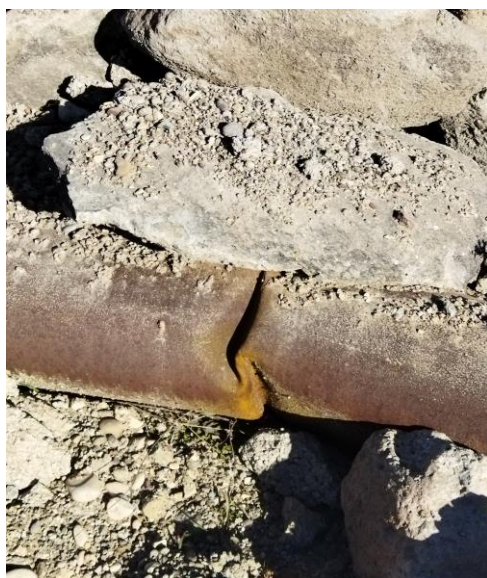
شکل (۲۳): آسیب‌دیدگی خطوط لوله در مسیر جاده آدیامان - قهرمان‌ماراش
